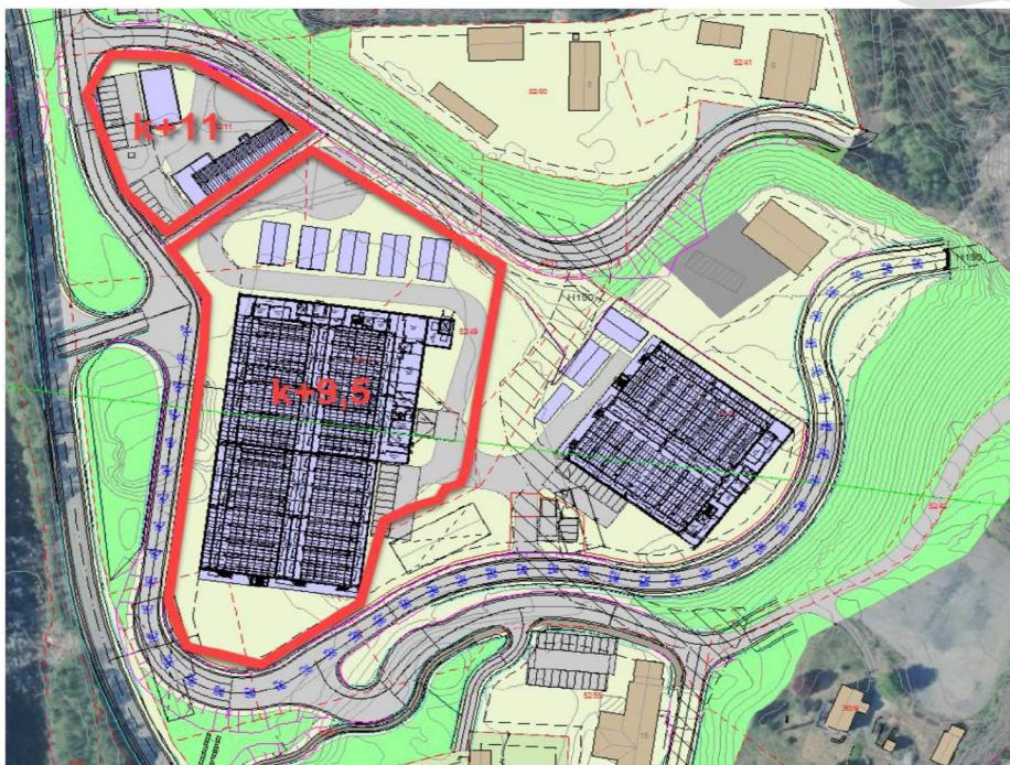
Figur 36: Illustrasjon som viser oppfylling av BOP og delar av BKB1. ( $46\ 000\ m^3$ )
