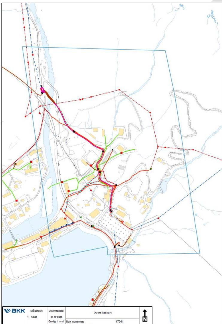
Figur 16: Oversiktskart som viser høgspenningsanlegg i jordkabel og luftstrekker i området.
