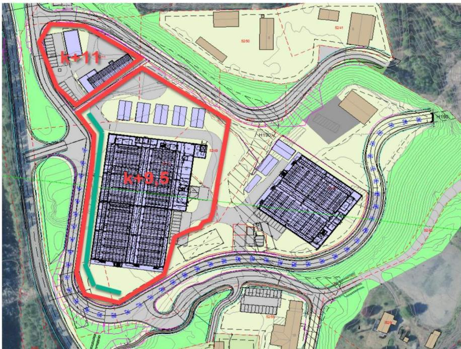
Figur 35: Illustrasjon som viser oppfylling av BOP og delar av BKB1 med avtrapping mot veg. ( $45\ 000\ m^3$ )
