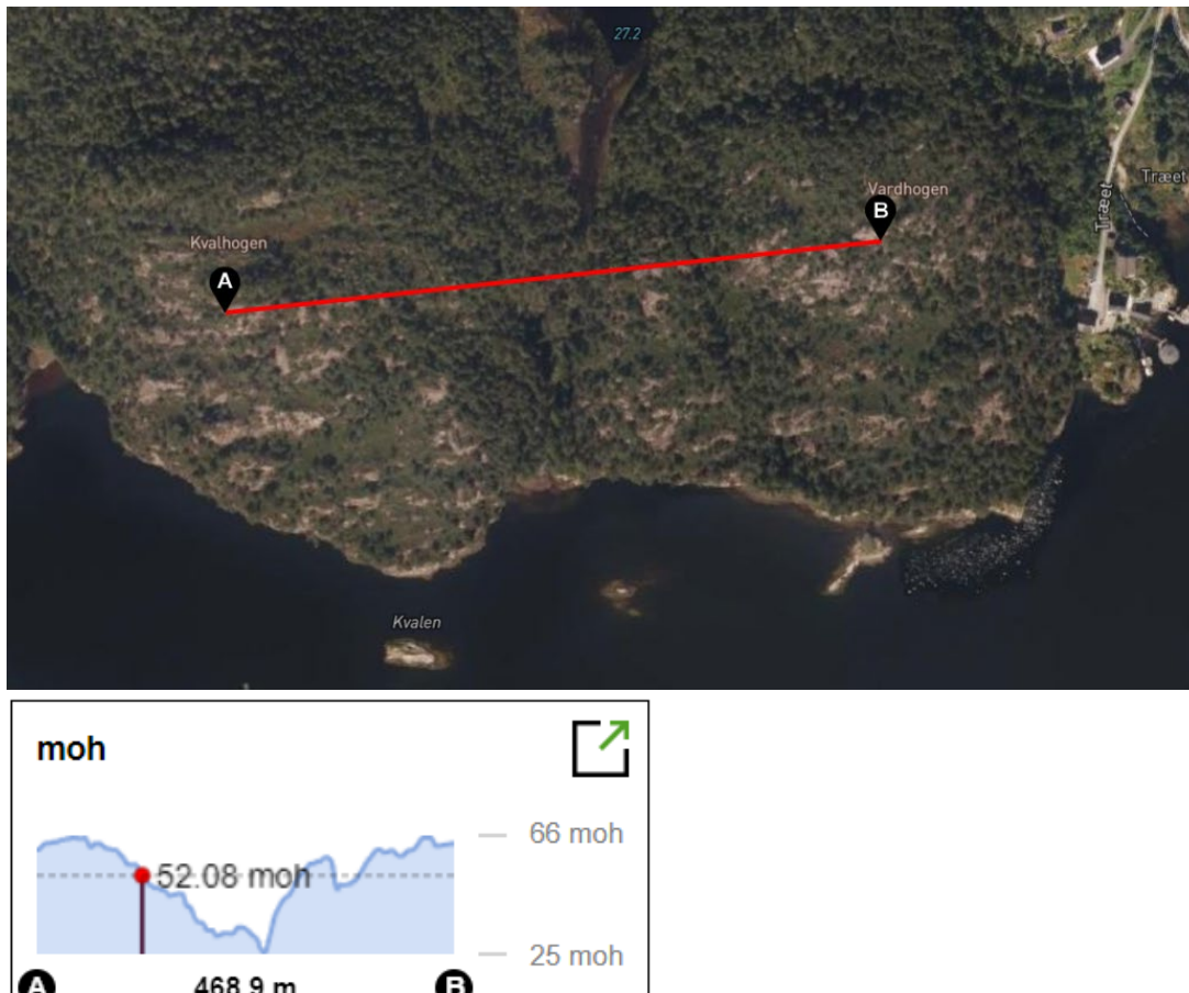
Figur 9. Terrengprofil gjennom planområdet.
